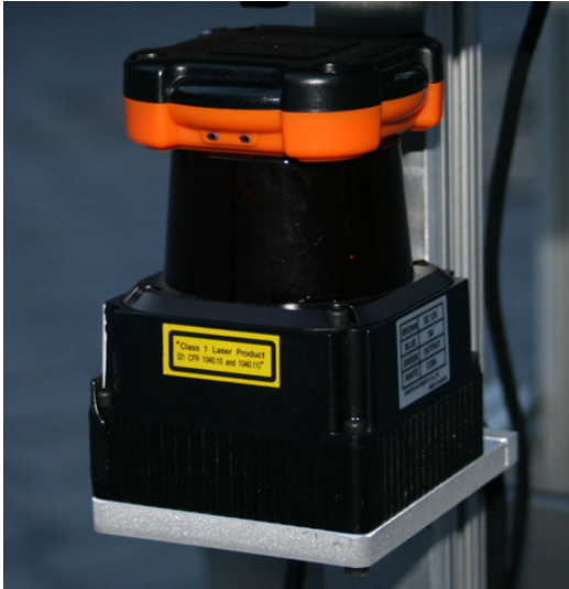
(d) UTM-30LX — 30m range, 270^\circ FOV, 0.25^\circ angular resolution, 40Hz update rate
