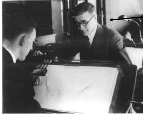
Operator's console of the Differential Analyzer (MIT Museum)
